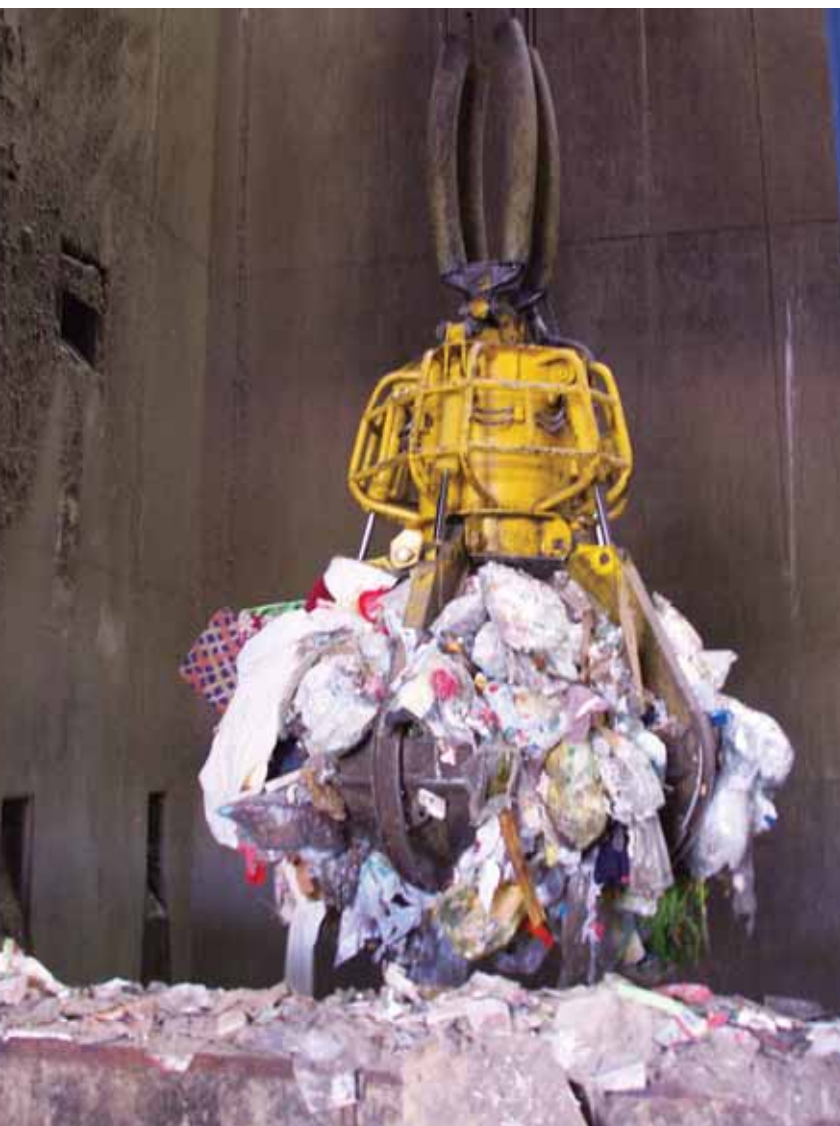
集められたごみをかき混ぜ、一掴みで約2.8トン焼却炉へ運ぶ巨大なクレーン。24時間休むことなく稼働しています。見た目はさながら巨大クレーンゲームの様で、見学に訪れた小学生に大人気!
